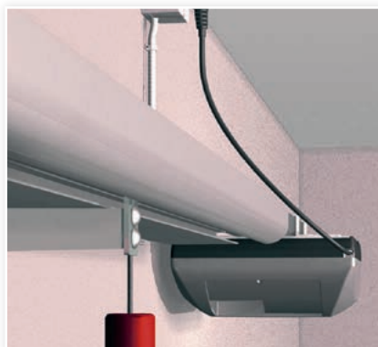
Le rail moteur est encastré dans le rail aluminium, il peut être placé en fonction des possibilités dans le rail linteau ou le rail retour. Galets de suspension sur chaque lame.
